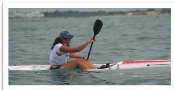
Le surf ski est un bateau directeur, dirigé avec l'assistance d'un gouvernail. Son étrave propose un plan de dérive efficace à l'avant. L'arrière est quant à lui plus planant, ce qui facilite le départ au planing pendant les sur-vitesses au surf.
